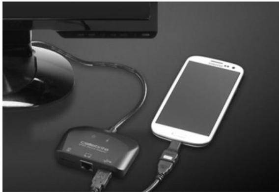
Ilustración 2. Conexión del celular a la estación de trabajo mediante dispositivo UFED 4PC. Fuente: recuperado de <https://teeltech.com/mobile-device-forensic-tools/cellebrite/ufed-4pc/>
