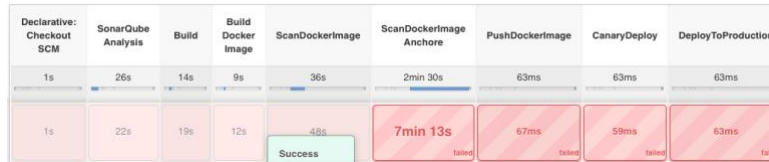
Imagen 12 Respuesta fallida del CI/CD en el paso de análisis de imagen contenerizada.
